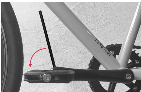
Die Pedale mit dem L kommt auf die linke Seite und wird an der Pedalachse entgegen des Uhrzeigersinns festgezogen (Drehmoment 35 NM).
