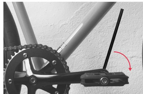
Die Pedale mit dem R kommt auf die rechte Seite und wird an der Pedalachse im Uhrzeigersinn festgezogen (Drehmoment 35 NM).
